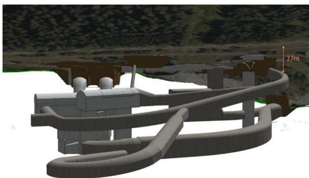
Slik blir tunnelsystemet nede i bakken ved det nye kraftverket ved Nedre Fiskumfoss
